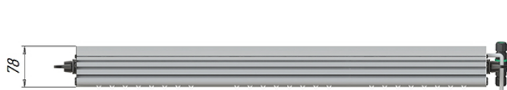
Светильник УСС-160 Эксперт Slim; крепление скоба, IP67
